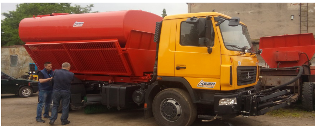
Дорожня комбінована машина піскороскидувач — поливомийна на базі МАЗ
